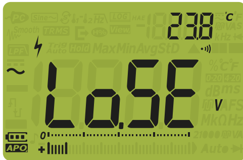
그림 3-2 낮은 V sense 감도 표시
